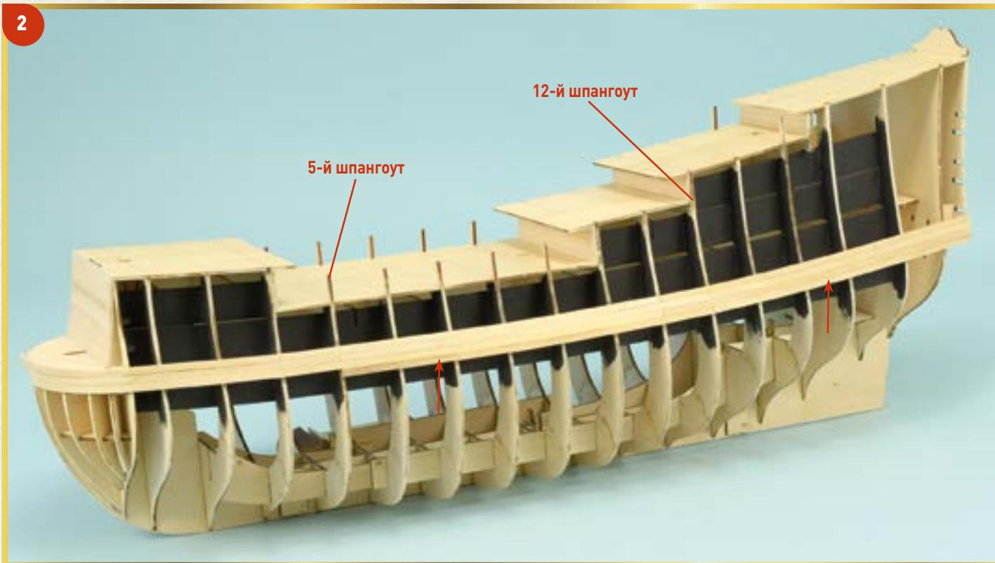
**2** Начните новый ряд планок обшивки, приклеив две планки в центральной и кормовой частях корпуса так, как показано на фотографии. Не забывайте постоянно чередовать шпангоуты, на которых расположены стыки планок одного ряда обшивки.
