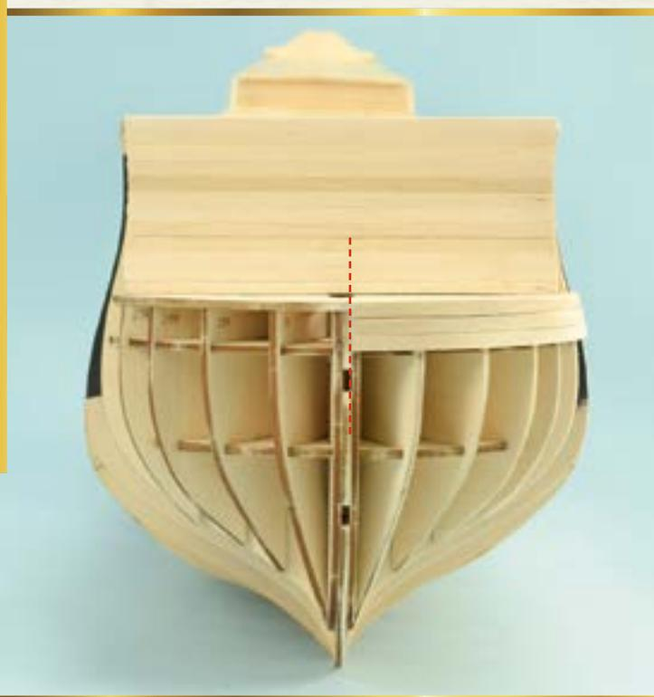
**4** Руководствуясь инструкциями данного и предыдущего выпусков, приклейте на правом борту корпуса такое же число планок обшивки, какое установлено у вас на левом борту. Обрежьте и обработайте концы планок носовой части так, чтобы у вас получился паз, ширина которого равна толщине килевой рамки.
