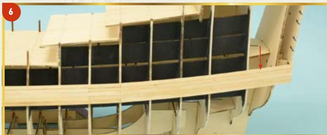
**6** Приклейте новую планку обшивки на кормовую часть каркаса рядом с предыдущей.
