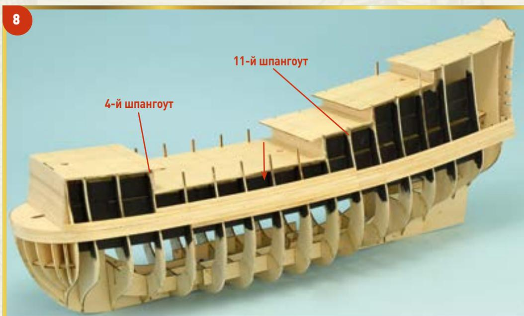
**7** Третья планка, приклеенная к носовой части корпуса, завершит этот пояс обшивки. Обрежьте планку на уровне слегка изогнутой носовой переборки, оставив небольшой припуск.
