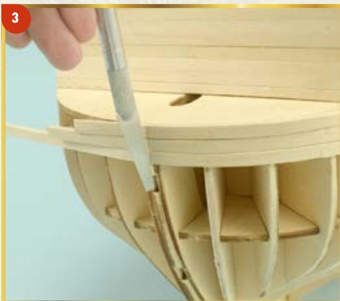
**3** Теперь перейдем к работе над носом модели. Обрежьте и обработайте концы планок так, чтобы они были заподлицо с внешним краем килевой рамки. Мы советуем отрезать планки, оставив хотя бы 0,5 мм запаса, после чего сделать их доводку с помощью надфиля.
